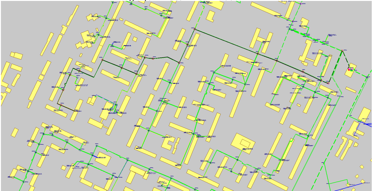
Рисунок 2.3 - Расчетный путь теплоносителя от ЦТП-1 до 02-ТП-ОТ-ул. Ефимова, 3
