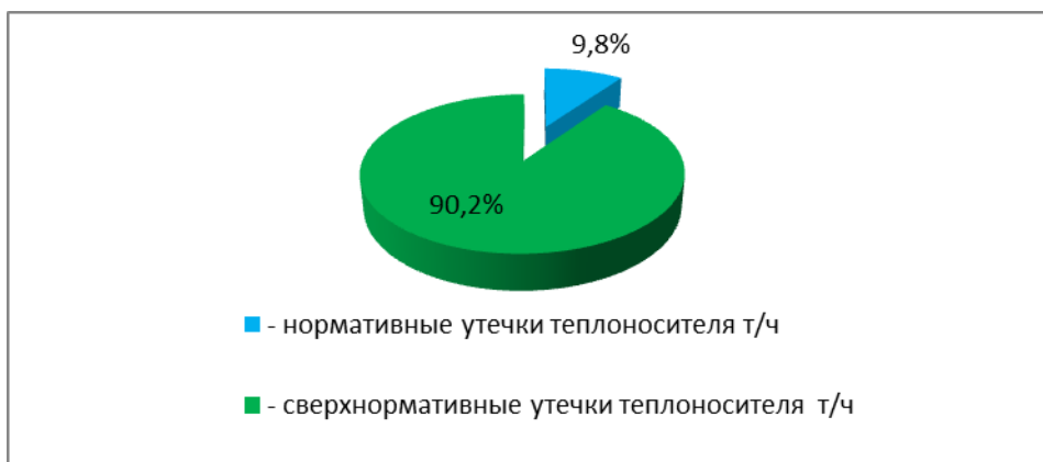
Рисунок 7.11 – Расход воды на подпитку тепловой сети в зоне действия котельной БИС
