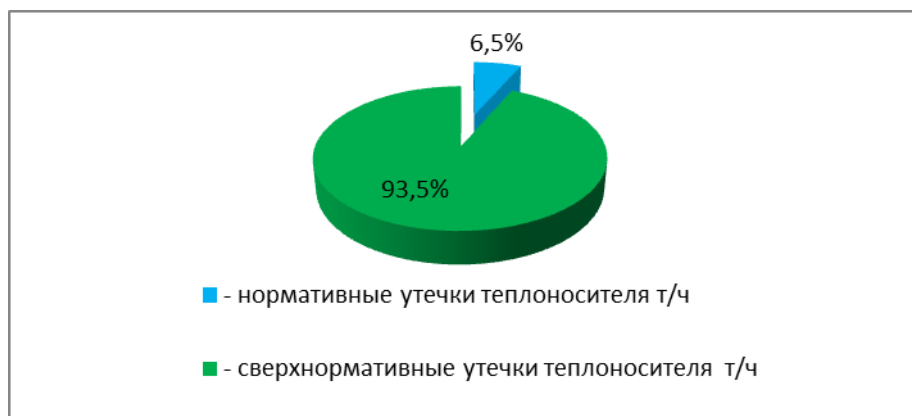
Рисунок 7.1 – Расход воды на подпитку тепловой сети в зоне действия котельной ж/д № 1
