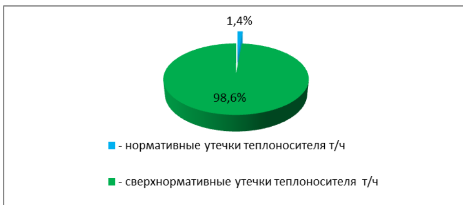
Рисунок 7.10 – Расход воды на подпитку тепловой сети в зоне действия котельной детского сада № 8
