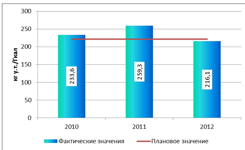
Рисунок 2.14 – Средневзвешенные фактические удельные расходы условного топлива на выработку тепловой энергии котельными ООО «ТСК ЮК» в 2010 - 2012 годах
