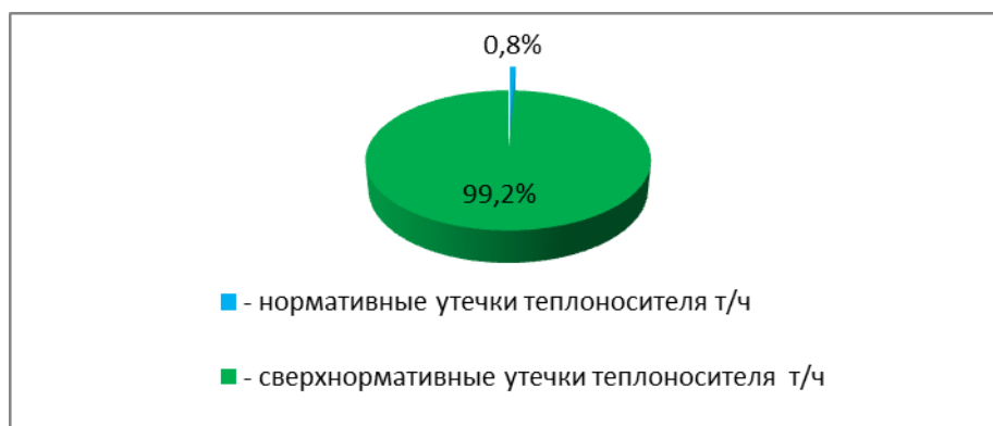
Рисунок 7.2 – Расход воды на подпитку тепловой сети в зоне действия котельной ж/д № 2
