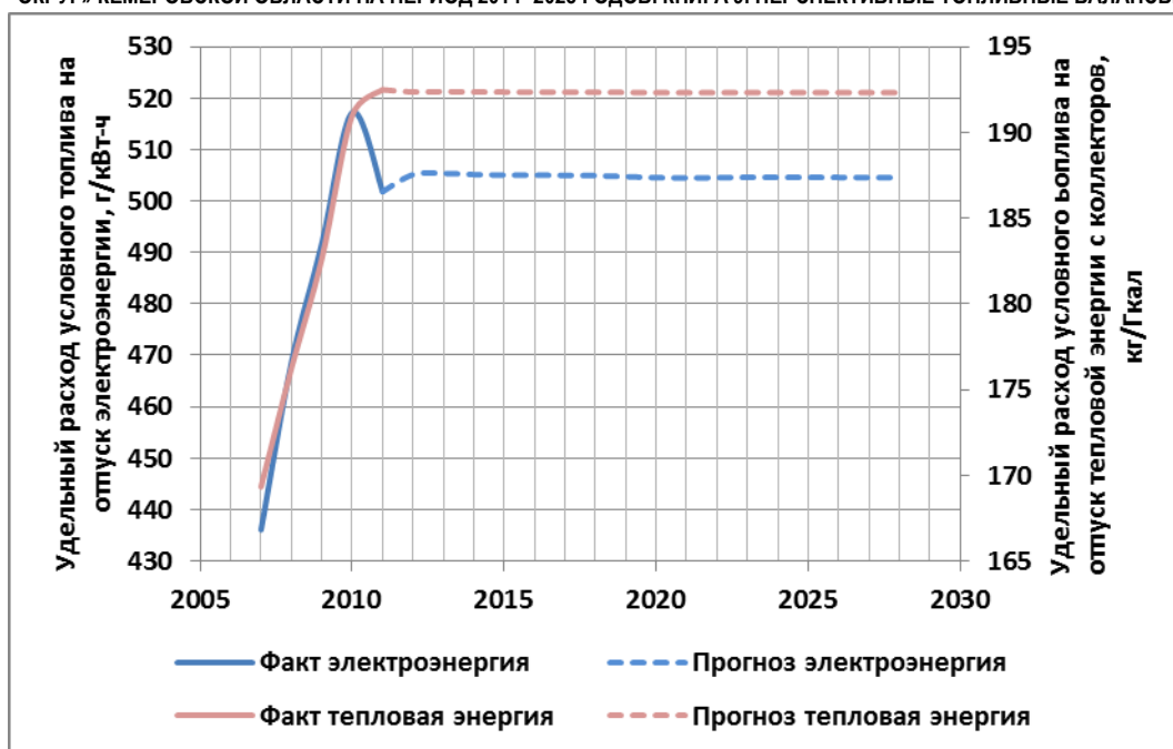
Рисунок 3.3 – Удельные расходы топлива на отпуск тепловой и электрической энергии на ЮК ГРЭС в 2007-2028 годах (вариант 2)
