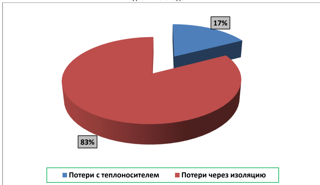
Рисунок 1.6 – Потери тепловой энергии в тепловых сетях
